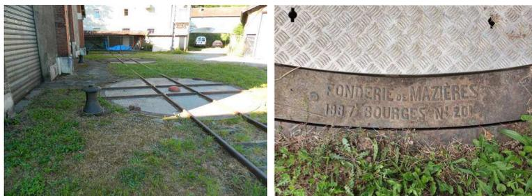
Les cabestans électriques qui permettent, par l'intermédiaire de poupées de renvoi encore nombreuses sur le site, de manipuler les wagons sans avoir recours aux locomotives. Le cabestan électrique de la Remise principale, dont le moteur date de 1931, a été remis en état de fonctionnement par les bénévoles de l'association.
