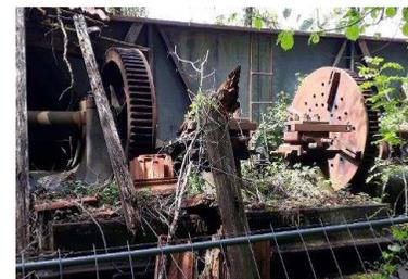
> La presse de 300 tonnes permettant de monter et démonter les roues sur les essieux, qui date de la construction du bâtiment
