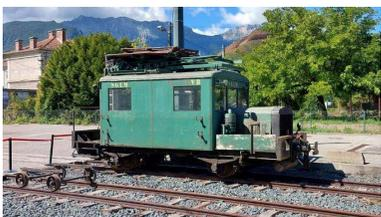
La draisine Decauville de 1966, équipée d'une tourelle d'inspection de la caténaire. Cette draisine est une version à voie métrique de la draisine lourde utilisée à la SNCF à la même époque. Ce véhicule est actuellement en phase de remise en état par les membres actifs de l'association
