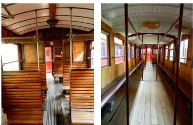
Les voitures « voyageurs » M19, B27 et B30 à bogies datant de 1915 et 1931 ; en particulier la voiture M19 transformée spécifiquement pour le transport des mineurs avec ses banquettes parallèles aux parois latérales et ses barres de maintien pour les voyageurs debout et leurs affaires (repas, outillage, habits de rechange, etc.)
